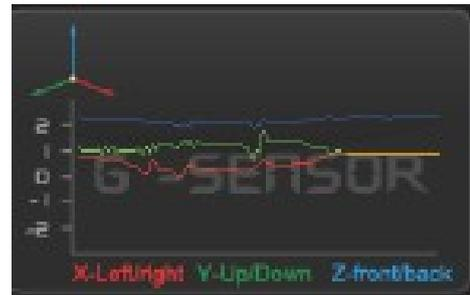
重力感測分析，當觸發G-Sensor強制錄影當下，將顯示車輛行徑時的加速度變化的資料。
